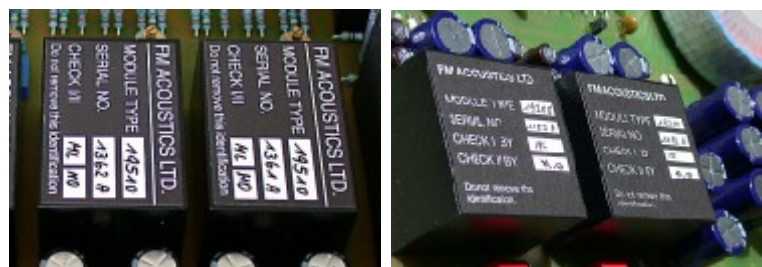
●ディスクリート・クラス A の HR モジュール、CMRR100dB を達成。
